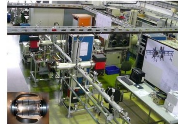
ZEA-1 Vakuumständer mit HF Gitter im Pumpkruz (1:1 Originalaufbau einer Einheit von Mitte Dipol - Dipol)
